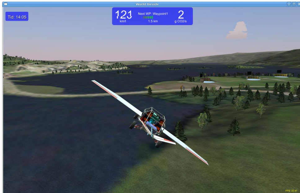
Figur 6. En måte å spare energi og redusere utslipp var å sette på vinger og glidefly fra toppen av åsen og ned mot mål. Simulering av aerodynamikk i World Beside gir realistisk oppførsel også for disse bilflyene.
